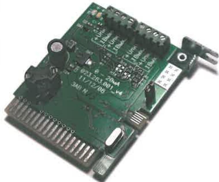
Плата токовых выходов предназначена для выдачи в реальном времени значений от одного до четырех измеряемых теплосчётом МКТС параметров в форме стандартных сигналов постоянного тока с диапазонами 0-5, 0-20 или 4-20 мА.
