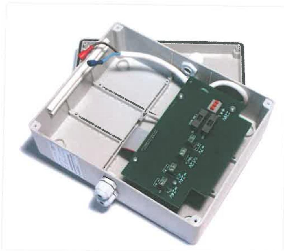
Обеспечивает питание системного блока СБ-05-0 и подключенных к нему ИМ. Выходное постоянное напряжение блока стабилизированное 24 В (имеются также выходы 8 В и 12 В), выходной ток ограничен на уровне 1,2 А.
