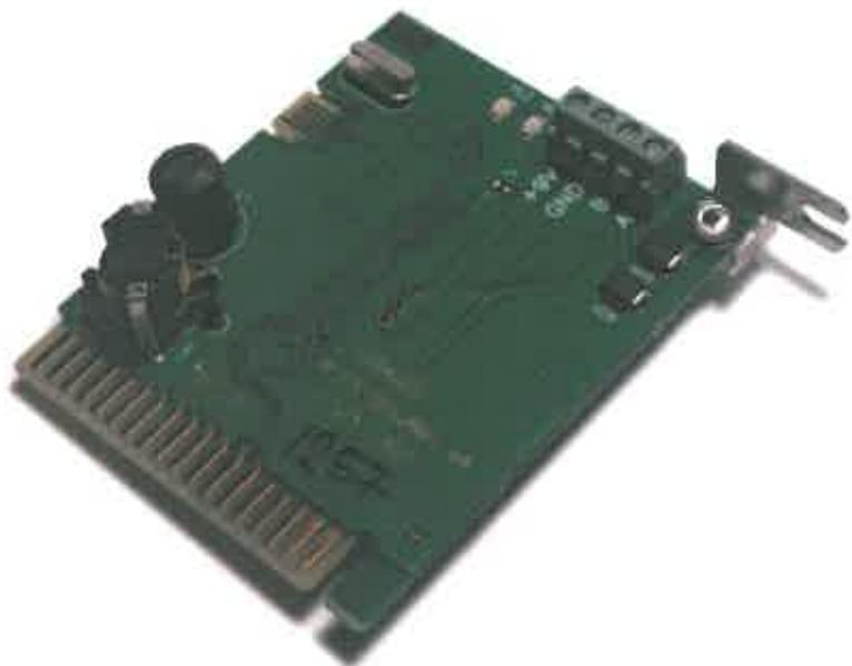
Плата RS485E предназначена для подключения теплосчетчика МКТС к информационным сетям и обеспечивает обмен данными между теплосчетчиком МКТС и ведущим устройством, снабженным интерфейсом RS-485 (например, персональным компьютером).
