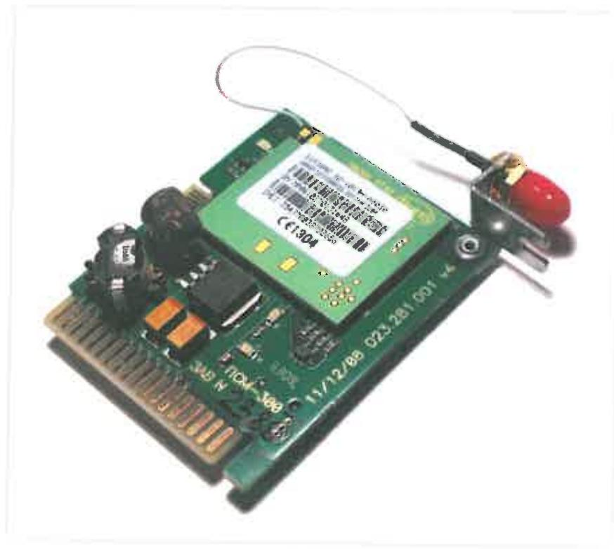
Плата сотового модема предназначена для обеспечения беспроводной связи диспетчерского пункта с теплосчетчиком МКТС, находящимся в зоне покрытия какой-либо сети сотовой связи стандарта GSM.
