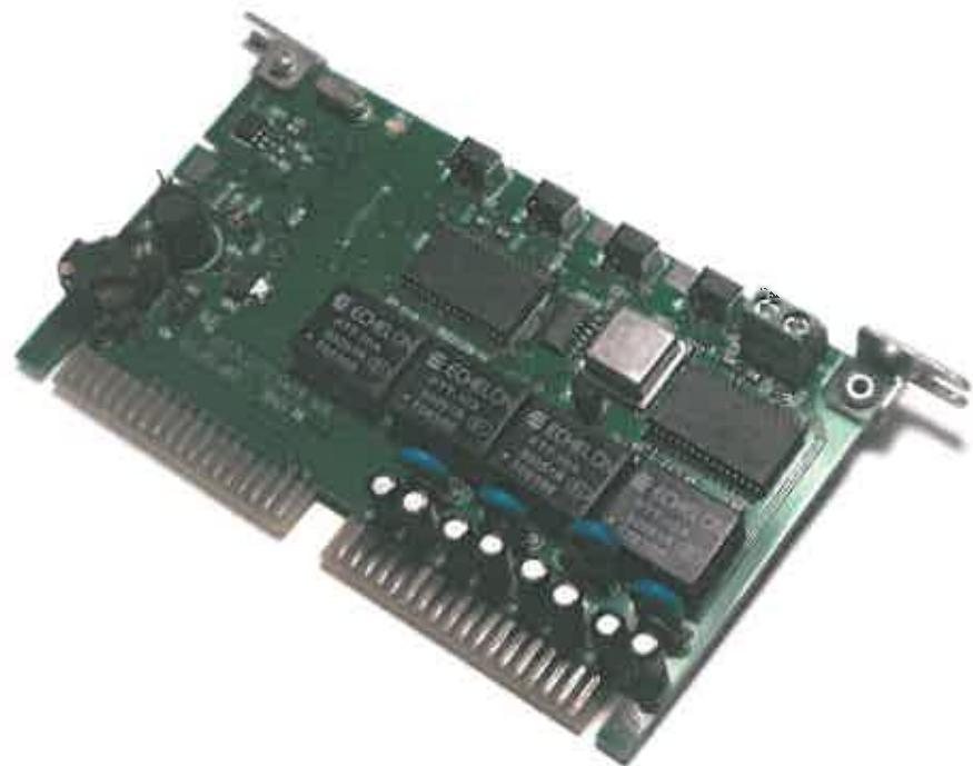
Плата интерфейса LonWorks предназначена для подключения теплосчетчика к сетям LonWorks.
