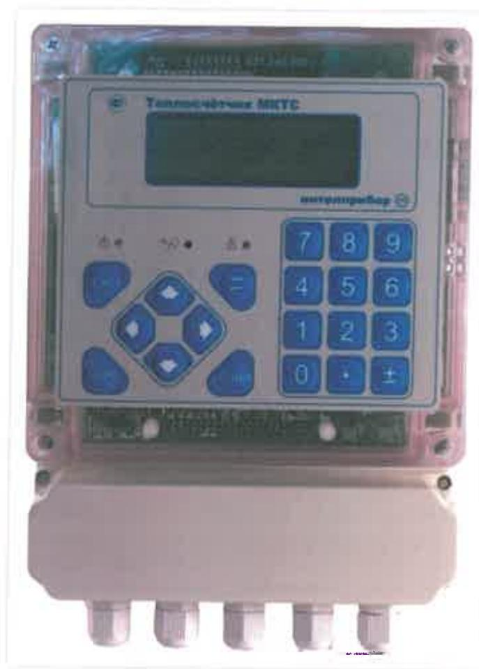
Эта модификация системного блока разработана для применения на локальных объектах с небольшой плотностью размещения узлов учёта. При сохранении структурной и программной преемственности со старшей моделью, системный блок исполнения СБ-05 имеет значительно меньшие габариты, вес, и, что немаловажно, стоимость. На типовых объектах количество узлов учёта обычно невелико, поэтому в
