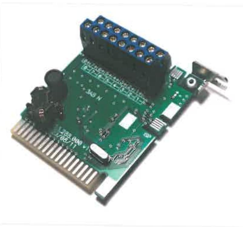
Плата дискретных выходов предназначена для формирования битовых управляющих сигналов по командам, принимаемым системным блоком через один из своих интерфейсов связи.
