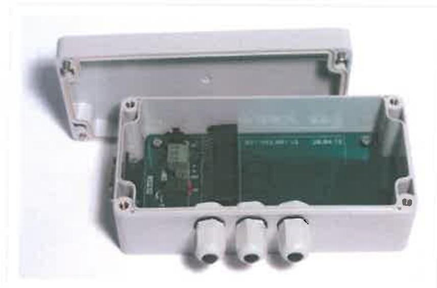
УППР предназначено для подключения к СБ МКТС одной платы расширения в том случае, если её непосредственная установка в слот системного блока нежелательна или невозможна (как, например, в лишённый слотов СБ-05).
