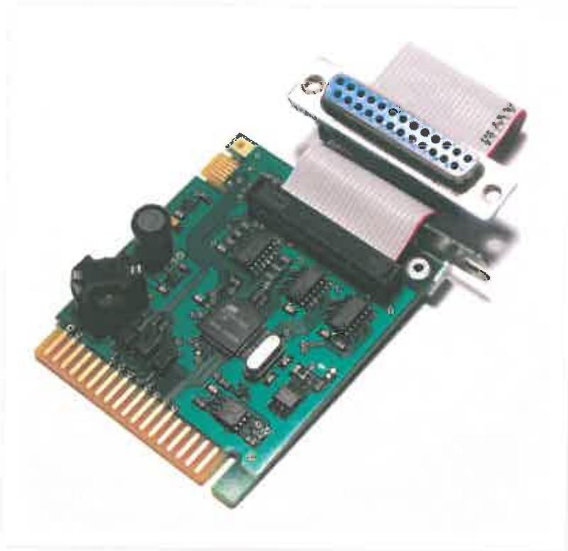
Устройство печати протоколов на принтер (УПП) предназначено для печати данных, содержащихся в архиве теплосчётчика, на матричном принтере, поддерживающем систему команд Epson. Принтер подключается с помощью кабеля типа Centronics непосредственно к СБ МКТС.
