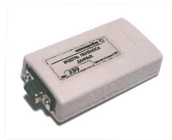
МПД предназначен для считывания данных архива из СБ МКТС и последующего переноса на компьютер диспетчерского пункта системы учета тепловой энергии. В отличие от выполняющего те же функции USB флеш-диска, МПД использует штатный интерфейс RS-232, присутствующий в СБ МКТС любой комплектации.
