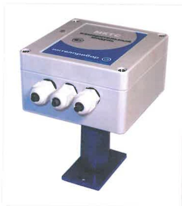
Измерительный модуль М021 применяют, когда нет необходимости использования электромагнитного преобразователя расхода. Его электронный блок аналогичен ЭБ измерительного модуля конструктивного исполнения И5 или К5. К нему могут быть подключены два преобразователя температуры, один преобразователь давления, а также расходомер с импульсным выходом.
