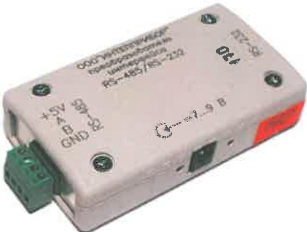
Преобразователь интерфейса RS-485/RS-232 ретранслирует сигналы двухпроводной полудуплексной линии связи RS-485 в сигналы интерфейса RS-232 и обратно. Он обеспечивает гальваническую развязку интерфейсов и автоматическое переключение режима прием/передача на линии связи RS-485 при скоростях обмена от 600 до 115 200 бод.
