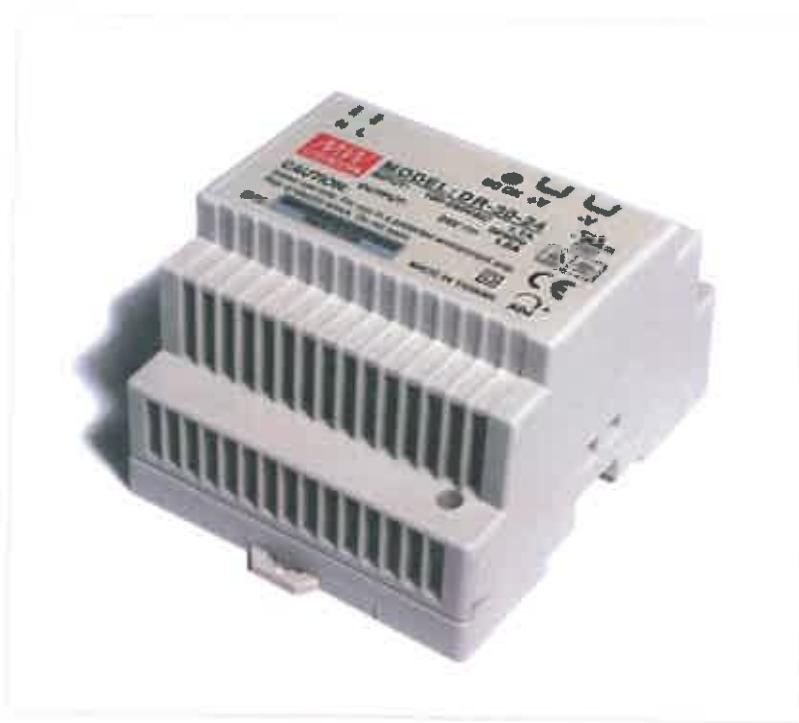
Обеспечивает постоянным напряжением 24 В системный блок СБ-05-0 и подключенные к нему ИМ. Источник питания имеет защиту от перегрузок по току и напряжению. Монтируется на DIN-рейку шириной 35 мм в монтажном шкафу или в ином защищённом от прямого воздействия влаги и пыли помещении.
