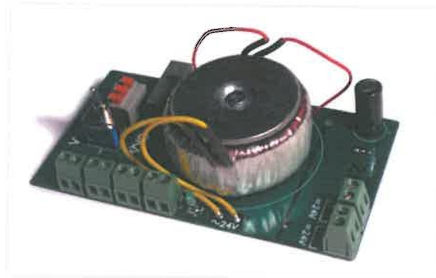
Источник питания предназначен для работы в составе системы регулирования температуры теплоносителя. Обеспечивает питание постоянным или переменным напряжением 24 В устройств, подключаемых к плате регулирования (привода регулирующего клапана и реле включения циркуляционных насосов).
