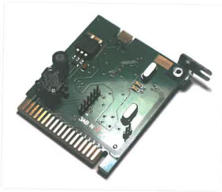
Плата USB обеспечивает автоматическую запись архива теплосчетчика на USB флеш-диск в виде файла данных специального формата с расширением .mkt.
