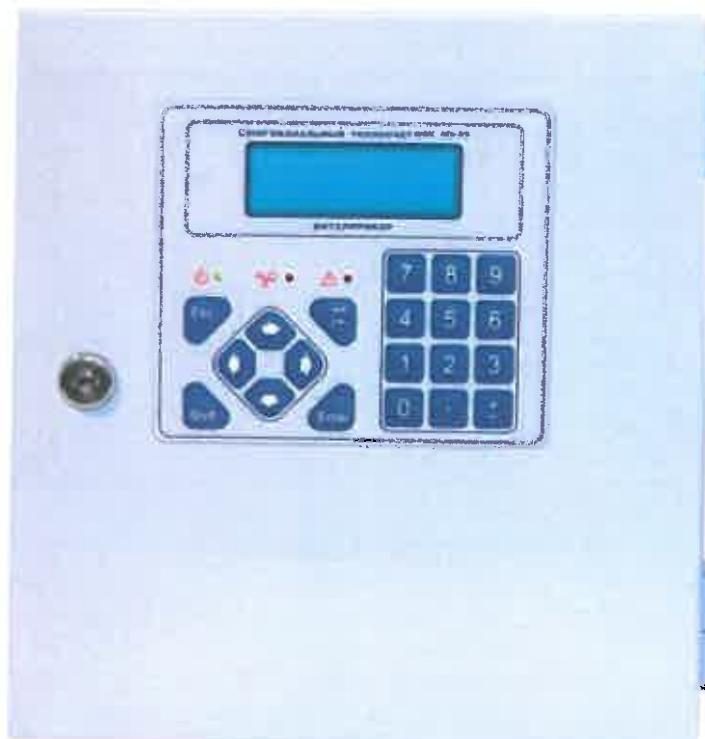
Системный блок принимает в цифровом формате данные от измерительных модулей, выполняет необходимые вычисления, архивирует данные и обеспечивает поддержку интерфейсов. Встроенный в СБ сетевой блок питания снабжает стабилизированным напряжением все узлы теплосчётчика, включая измерительные модули.
